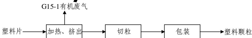
图 3.9.10-1 塑料片造粒工艺流程及产污节点图
